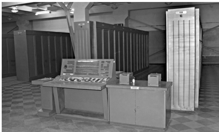
Рис. 2.2. ЭВМ К340А: 20 шкафов, установленных в три ряда, инженерный пульт и регистратор
